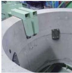
内径900mmのマンホール直壁の内面にプレートを施工し、レベル2地震動相当の水平力を与え水平変位が5mm以下であることを確認する。また、構成部材に外観異常が見られないことを確認する。
