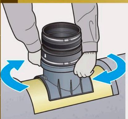
封印シールをはがして、ハンドルを一回転半(時計回り)させ、ストッパー位置まで締込みます。
