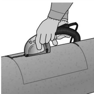
製品取付部分をディスクグラインダー等で切断し既設管を取り除きます。切断深さは管厚の70%以上です。
